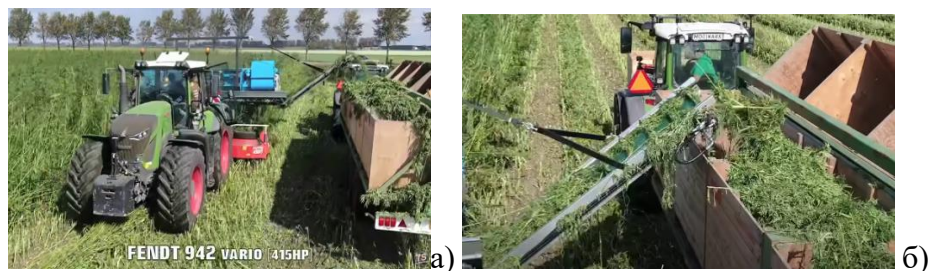
Рисунок 4 - Технологічний процес зрізування суцвіть конопель а) та їх передачі до транспортного засобу в супроводжувальному режимі б)
