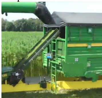
Рисунок 2 – Фрагменти транспортування листової біомаси конопель до причіпного бункера та з нього до транспортного засобу
