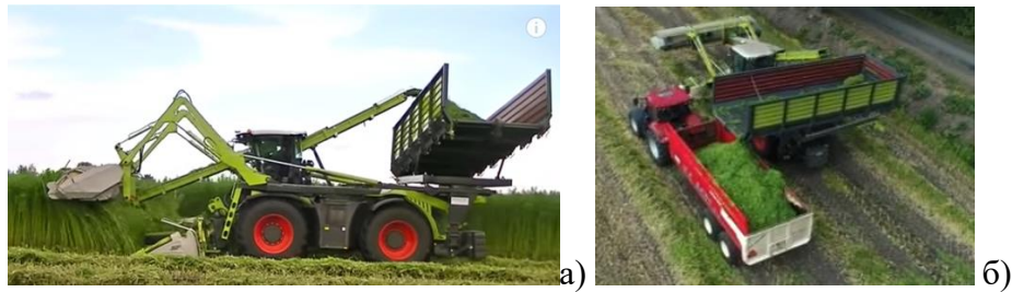
Рисунок 3 – Збирання біомаси суцвіття та стеблової маси конопель збиральним комплексом Claas Xerion 4000
