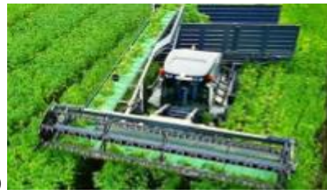
Рисунок 5 – Комбайн для збирання суцвіть конопель: а. Загальний вигляд спеціалізованого комбайну Multi Combine HC 3400 Hemp а) Технологічний процес збирання суцвіття конопель по технологічним коліям
