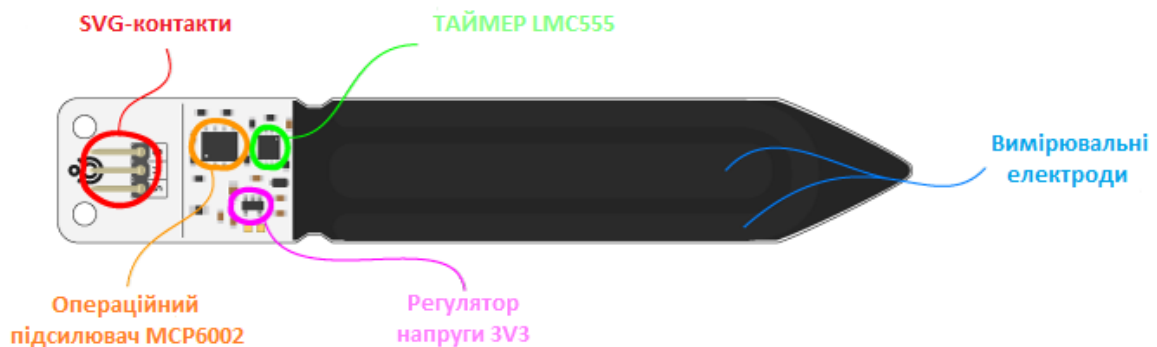
Рис. 1 – Конструктивний вигляд ємнісного датчика
