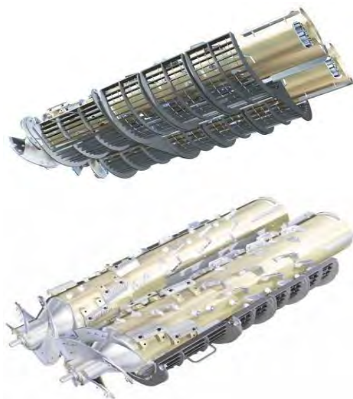
Рис. 2. Схема обмолоту та сепарації комбайна New Holland CE 9080
