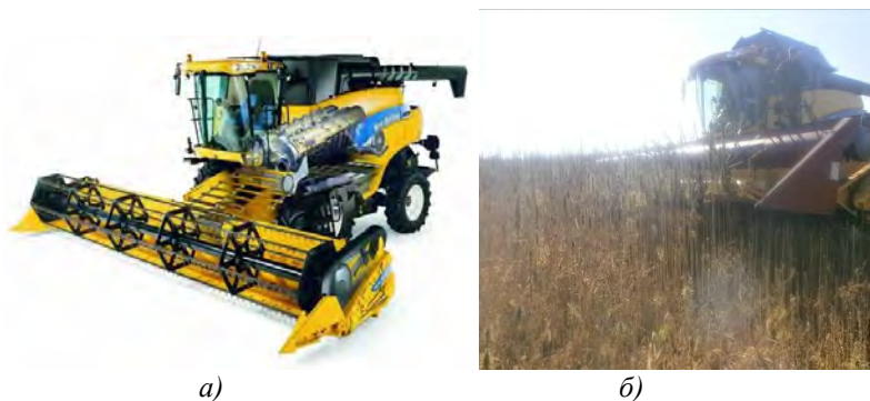
Рис. 1. Зернозбиральний комбайн New Holland CE 9080 із жатками зерноюю (а) та для збирання соняшнику (б)
