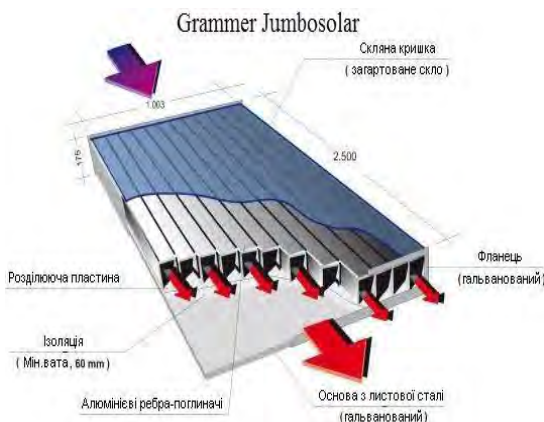
Рис. 5. Конструкція сонячних повітронідогрівачів, що найбільш масово виробляються у світі
